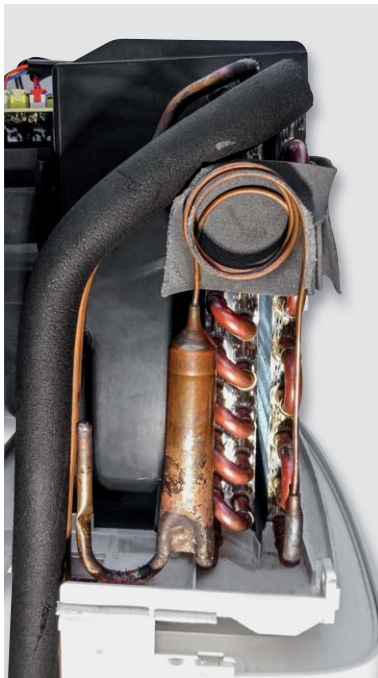
Bild 6: Hier ist das druckmindernde Kapillarrohr zu sehen.
