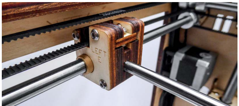
Bild 11: Ausgeklügelte Konstruktionen – die Führungsblöcke für die X-/Y-Achsen
