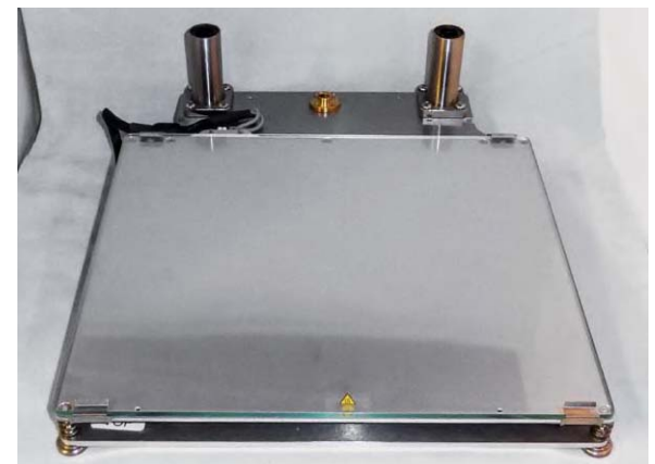
Bild 14: Solide Konstruktion – Druckbett mit Heizung, Glasplatte und Dreipunktnivellierung
