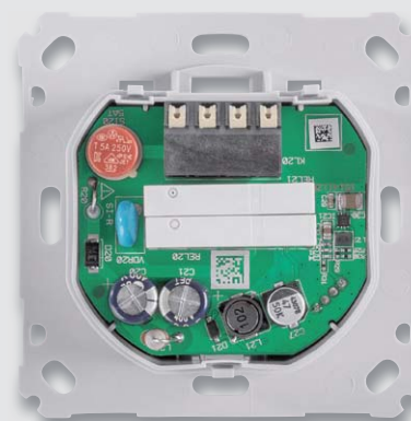
Bild 12: Die Leistungsplatte wird mit der Buchsenleiste in die Stiftleiste der Controllerplatte eingesetzt ...
