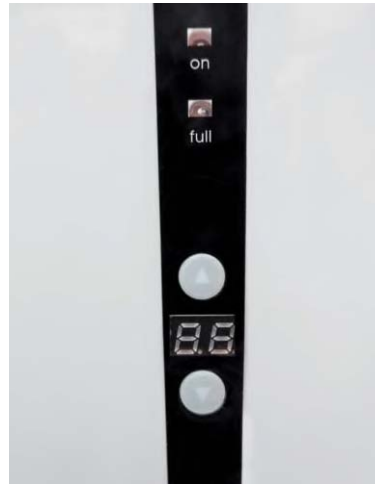
Bild 12: Das übersichtliche Bedien- und Anzeigefeld des Peltier-Luftentfeuchters
