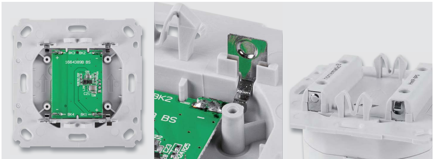
Bild 14: So erfolgen das Einsetzen der Anschlussplatine in das Gehäuse sowie das Aufsetzen des zuletzt zu verschraubenden Montageteils auf die Batteriekontakte.
