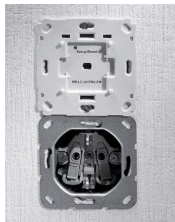
Bild 19: ... wird in die Installationsdose eingesetzt und verschraubt.
