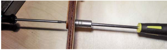
Bild 7: Praktische Hilfe bei der Montage – ein Steckschlüssel der Größe 5,5 mm
