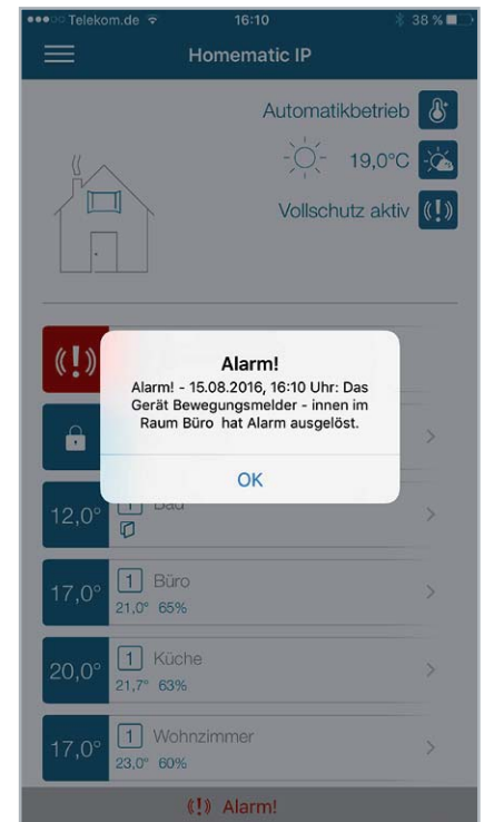
Bild 2: Bei einer Alarmauslösung erscheint umgehend eine Push-Nachricht auf dem Smartphone.
