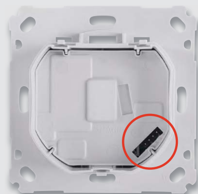
Bild 11: Vor dem Einlegen der Leistungsplatte ist die Isolierplatte einzulegen, und zwar so, dass der Ausschnitt für die Stiftleiste mit dieser korrespondiert.
